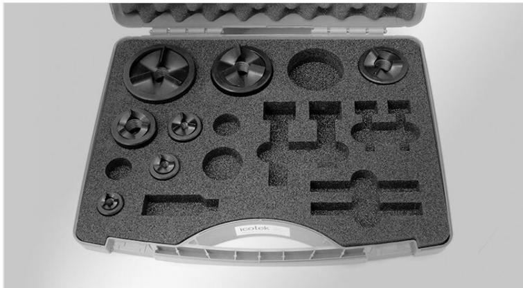
ステンレス・鋼板・アルミ・プラスチック用穴開けパンチダイスです。種類に応じて廃棄物（切抜き片）をいくつかのパーツに分割することで、廃棄物が油圧スクリューやダイに詰まることを防ぎます。手動および油圧操作対応です。
